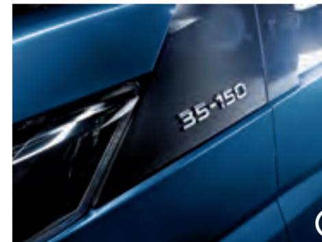
Die neue Kennzeichnung für den DAILY ist einfach und intuitiv: Die Typisierung gibt die zulässige Gesamtmasse (Wert x 10) in Kilogramm und die Leistung in PS (gerundet) an. Beispiel: 35-150 – 3.500 kg zGM und 146 PS.
