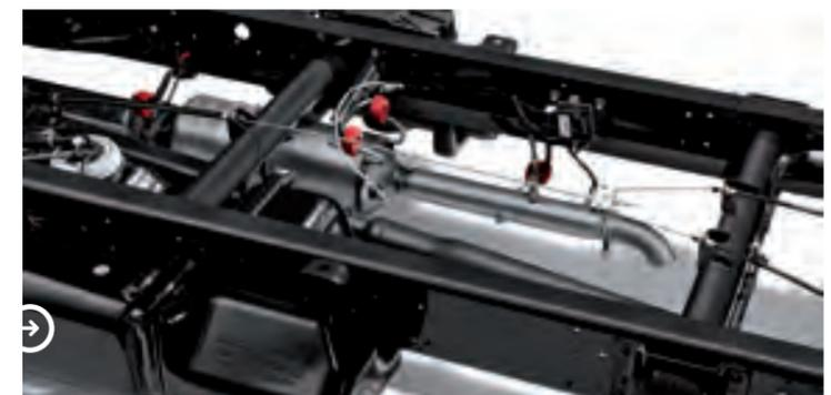
Der Leiterrahmen des Neuen DAILY – eine solide Konstruktion für maximale Zuverlässigkeit.
