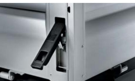
Entriegelungshebel der klappbaren Pritschenwände
