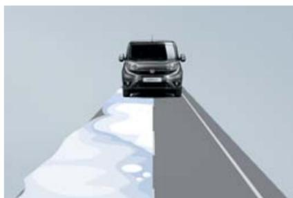
**Traction+**, das innovative Kontrollsystem, steigert den Antrieb des Fahrzeugs auf schwierigen Terrains oder auf Bodenbelägen mit geringer Haftung. Bei geringer Bodenhaftung eines Antriebsrades erkennt die Systemsteuerung die Rutschgefahr und bremst das Rad ab. Das Antriebsmoment wird auf das Rad mit der höchsten Bodenhaftung übertragen. Auf diese Weise wird die Fahrbarkeit des Fahrzeuges bei Aufrechterhaltung der Richtungsstabilität und der Lenkbarkeit ermöglicht.
