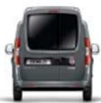
Hecktür mit 2 verglasten Flügeln
