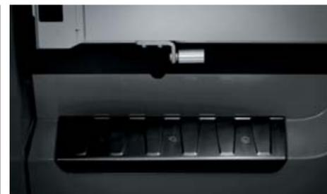
Ablagefach mit Schloss für Werkzeuge mit einer Länge von bis zu 2 Meter.
