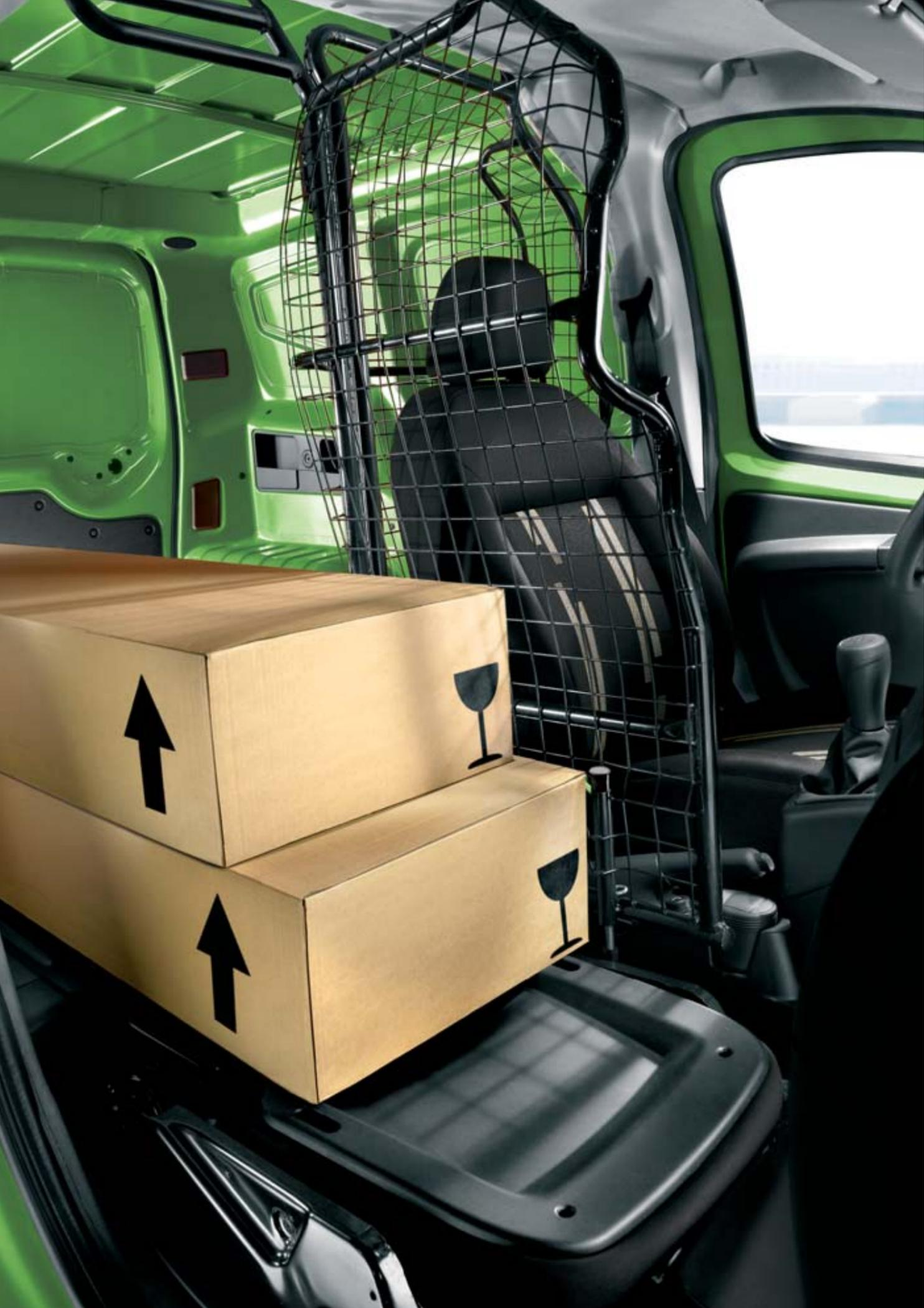
Dank der Möglichkeit, den Beifahrersitz vollständig im Fahrzeugboden zu versenken, lässt sich die Länge des Laderaums um fast einen Meter verlängern und das Volumen um 0,3 m<sup>3</sup> erhöhen, sodass auch lange Gegenstände problemlos transportiert werden können.
