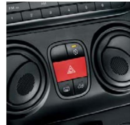
Die Start&Stop-Vorrichtung schaltet den Motor bei kurzzeitigem Fahrzeugstopp selbstständig ab, zum Beispiel an der Ampel. Wird die Kupplung getreten, wird der Motor automatisch wieder gestartet. Die Start&Stop-Vorrichtung, optional erhältlich bei allen Fahrzeugen mit Diesel-Euro-5-Motorisierung, reduziert den Kraftstoffverbrauch und die CO<sub>2</sub>-Emissionen deutlich.
