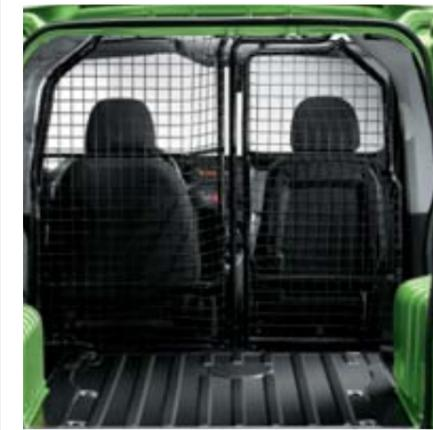
Zweiteilige Trennwand mit Schutzgitter: fixes Element auf der Fahrerseite, drehbares Element auf der Beifahrerseite, in Kombination mit dem im Fahrzeugboden versenkbaren Beifahrersitz.
