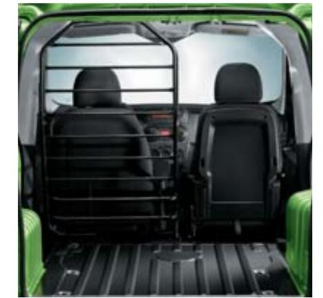
Leiterförmige Stahlrohrkonstruktion zum Schutz des Fahrers.
