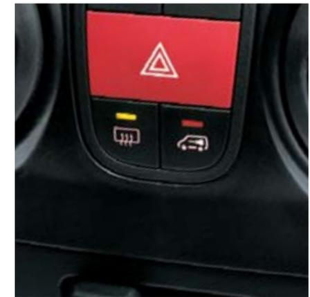
Die Verriegelung der Vorder- und Hecktüren erfolgt unabhängig voneinander. Dadurch haben Sie auch dann Zugang zum Laderaum, wenn die Fahrerkabine abgeschlossen ist, und profitieren bei Be- und Entladevorgängen von erhöhter Sicherheit.
