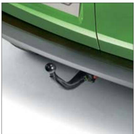
In deri Konfigurationen erhältliche **Anhängerkupplung**: zwei feste und eine abnehmbare.
