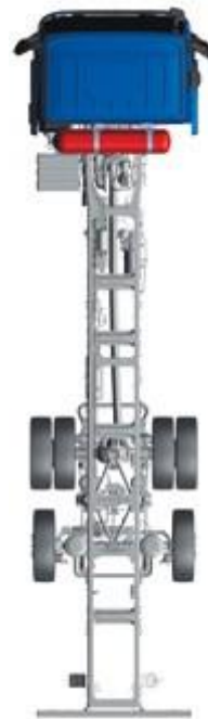
CNG - hinter der Kabine
